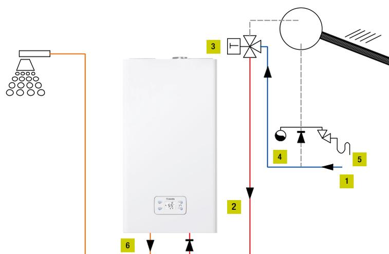
Gli IDRABAGNO Lx dispongono della funzione solare, attivabile attraverso il pannello comandi, se installati in un sistema solare termico per la produzione di ACS, consentendo il massimo risparmio energetico.
