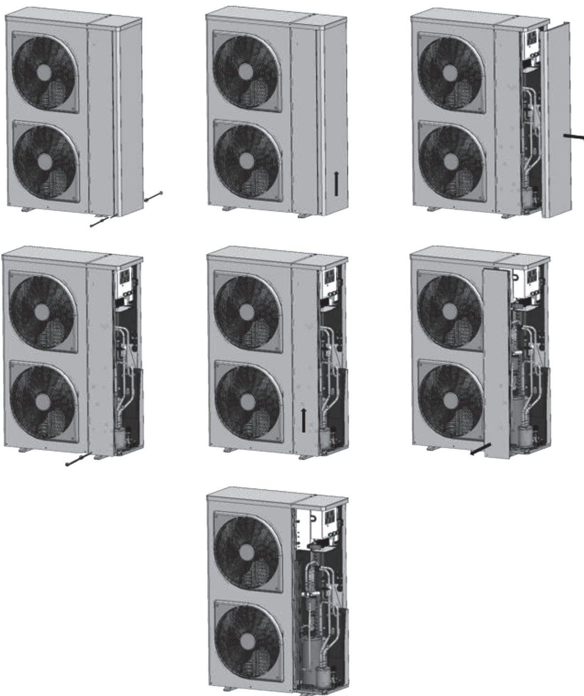
Ilustracja 5: Sposób zdejmowania przedniego panelu urządzeń o mocy od 12 do 14 kW
